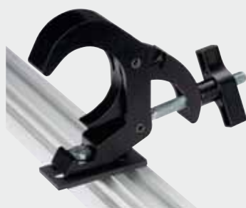
Těžké provedení závěsu na trubky s průměrem cca 50 mm. Nosnost 110 kg.
